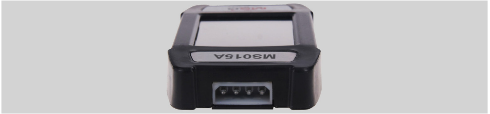
Figura 2. Conector para conectar el cable de diagnóstico.
