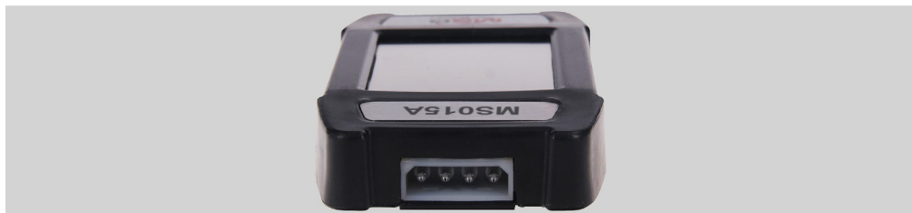
Rysunek 2. Złącze do podłączenia kabla diagnostycznego
