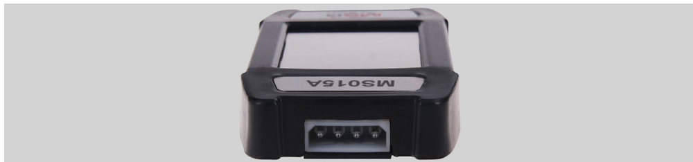
Рисунок 2. Разъём для подключения диагностического кабеля
