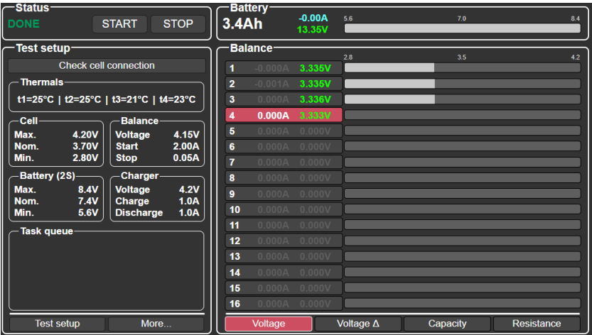
Рисунок 11. Приклад повідомлення про відсутність підключення одного затискача «крокодил» на 4 елементі
