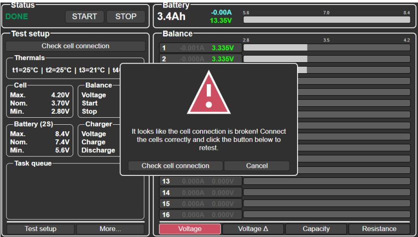
Рисунок 12. Повідомлення про відсутність підключення затискача(ів) «крокодил» до комірок по краям батареї
