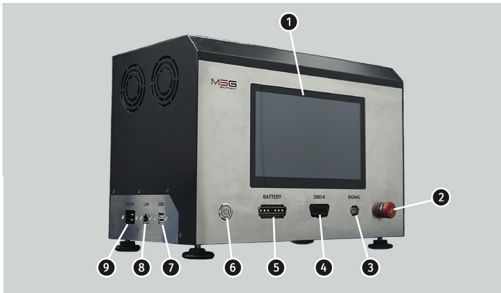
Figura 1. Principales elementos del probador
