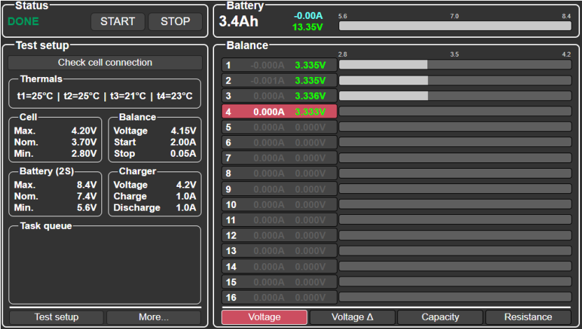
Rysunek 9. Przykład informacji o braku podłączenia zacisku „krokodyl” na 4. Ogniwie
