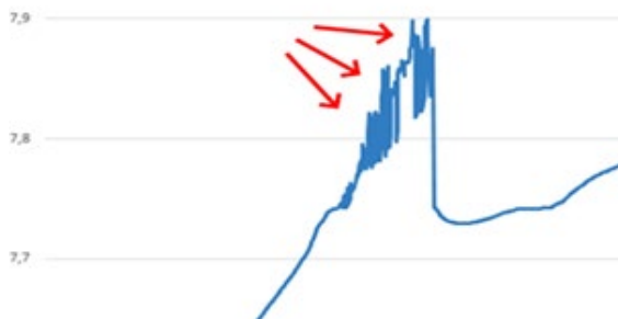
Figura 16. Variación de tensión en el módulo si los terminales no están bien conectados.
