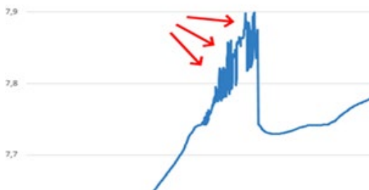
Rysunek 16. Zmiana napięcia na module przy słabym podłączeniu zacisków
