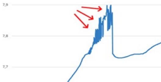
Рисунок 16. Изменение напряжения на модуле при плохом подсоединении зажимов
