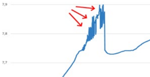
Рисунок 16. Зміна напруги на модулі в разі поганого приєднання затискачів
