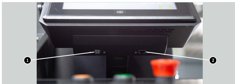
Figura 4. Ubicación de los conectores USB y LAN
