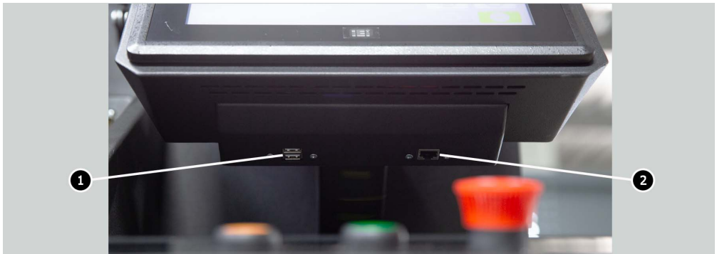
Abbildung 4. Anordnung der USB- und LAN-Anschlüsse
