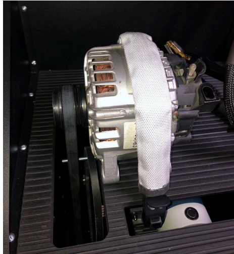
Abbildung 14. Montage und Fixierung des Generators auf dem Prüfstand
