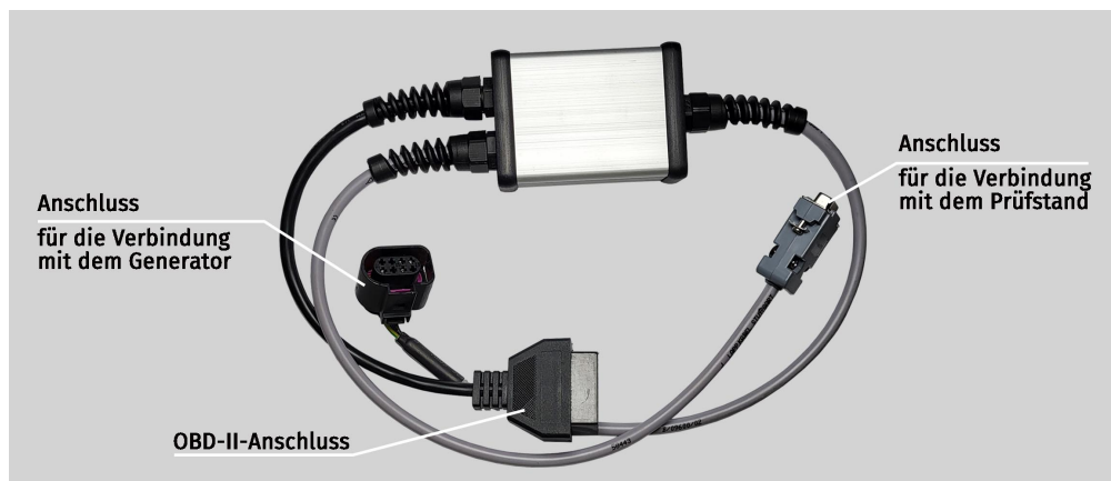
Abbildung 8. Kabel zur Prüfung von riemengetriebenen Starter-Generatoren 48 V
