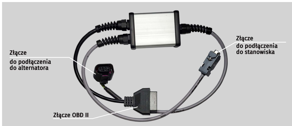
Rysunek 8. Kabel do badania pasowych alternatorów-rozruszników 48 V
