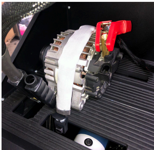
Abbildung 16. Anschluss der Leistungskabel an den Generator
