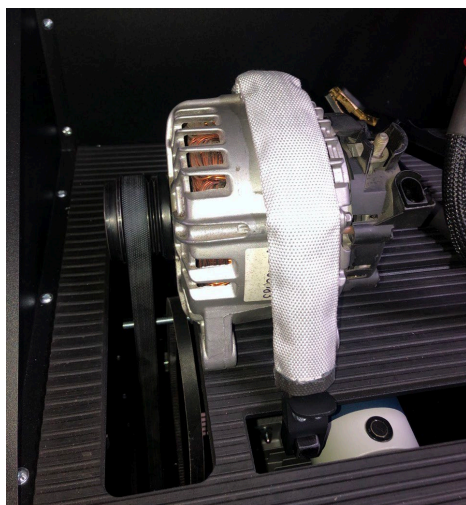
图 14. 交流发电机在测试台上的安装与固定
