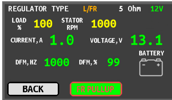
Рисунок 10. Екран діагностики регулятора L/FR (12/24V)
