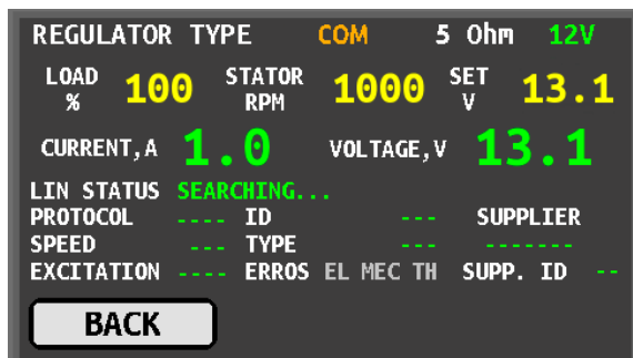
Rysunek 12. Ekran diagnostyczny regulatora COM 12V
