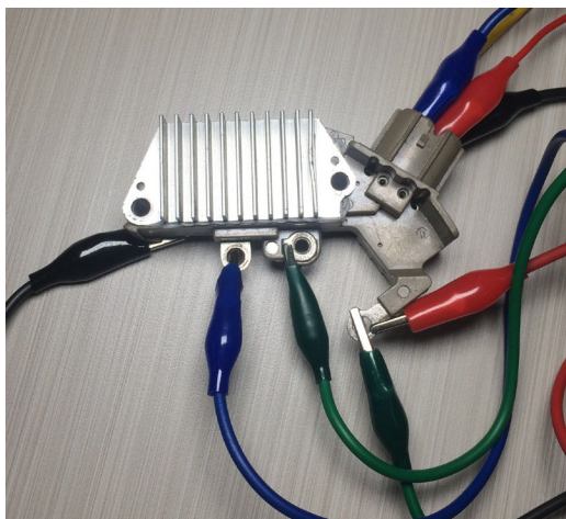
Рисунок 18. Регулятор ARE6076, подключённый к разъёмам тестера
