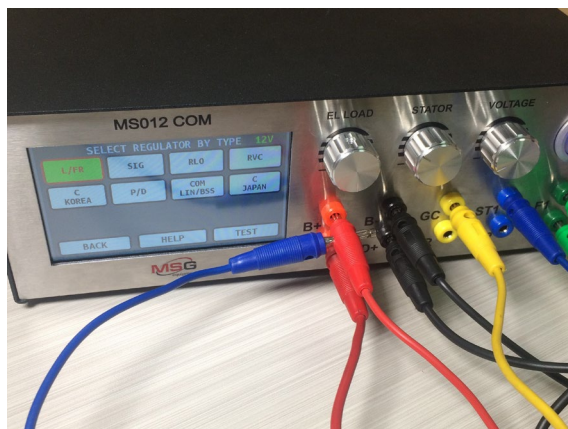
Figura 19. Conexión de un cable B+ adicional
