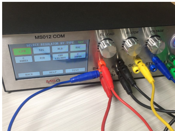
Рисунок 19. Подключение дополнительного провода B+
