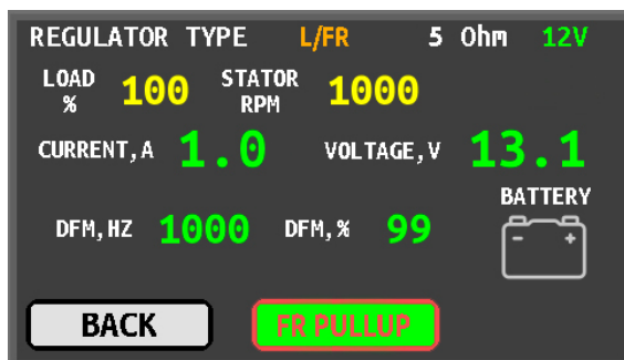
Рисунок 10. Экран диагностики регулятора L/FR (12/24V)
