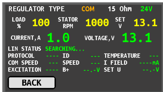
Рисунок 13. Экран диагностики регулятора COM 24V
