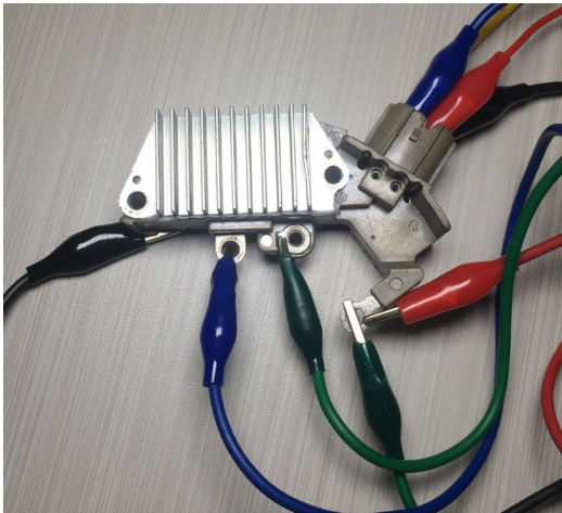
Рисунок 18. Регулятор ARE6076, під'єднаний до роз'ємів тестера
