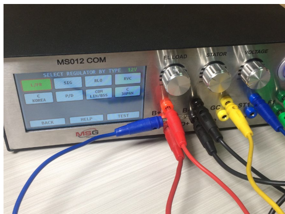
Rysunek 19. Podłączenie dodatkowego przewodu B+
