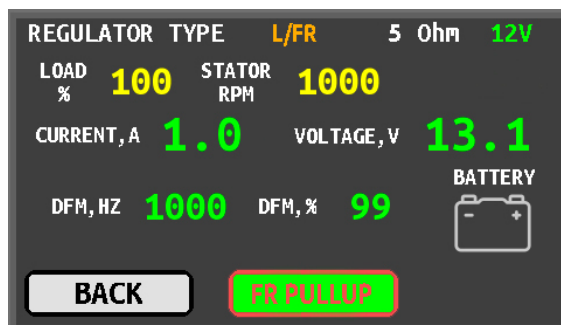
Rysunek 10. Ekran diagnostyczny regulatora L/FR (12/24V)
