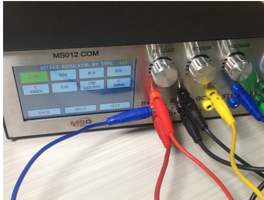
Рисунок 19. Підключення додаткового проводу В+
