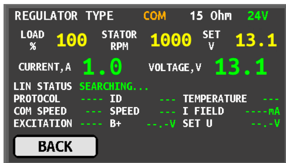
Rysunek 13. Ekran diagnostyczny regulatora COM 24V
