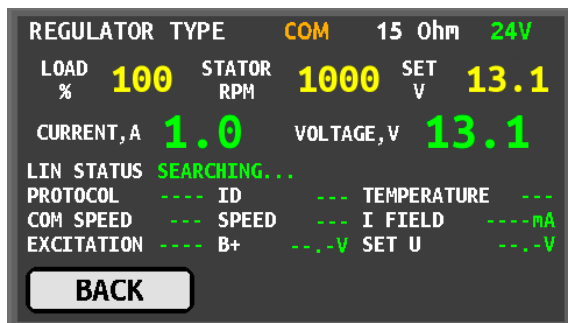
Рисунок 13. Екран діагностики регулятора COM 24V
