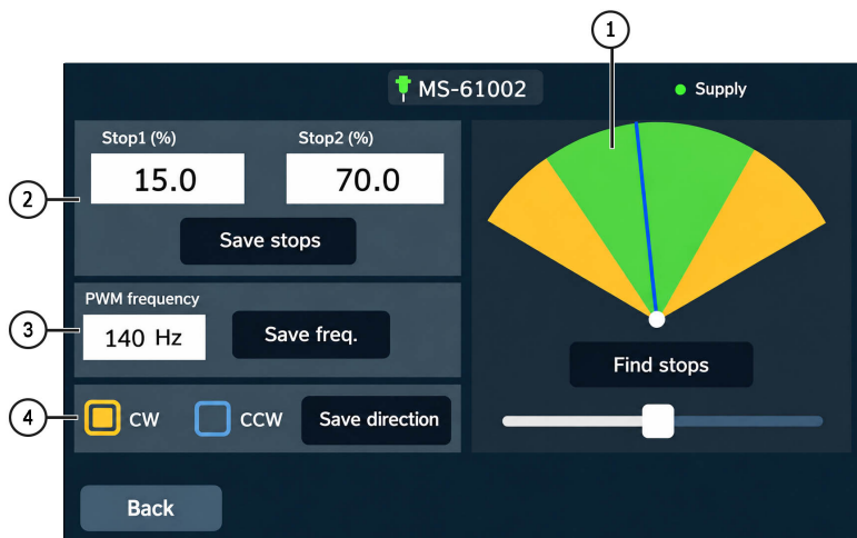
Figura 16. Pantalla de programación de actuadores CAN Hella
