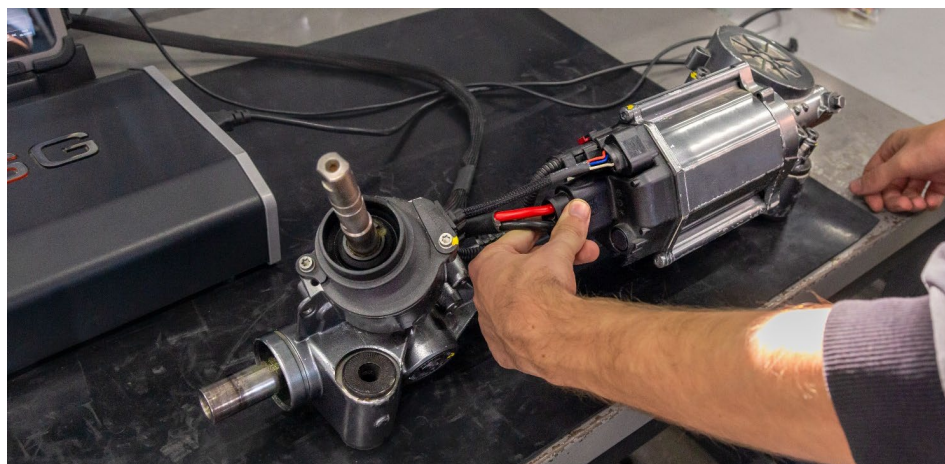
Figura 3. Conexión de una unidad EPS al tester
