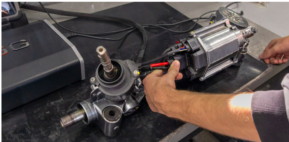
Rysunek 3. Podłączenie zespołu EPS do testera
