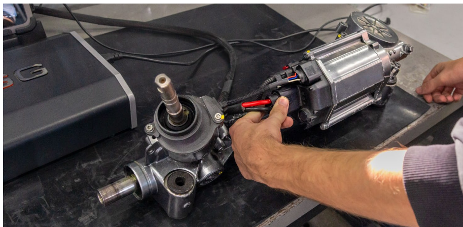
图3. 将电子助力转向系统（EPS）总成连接至测试仪
