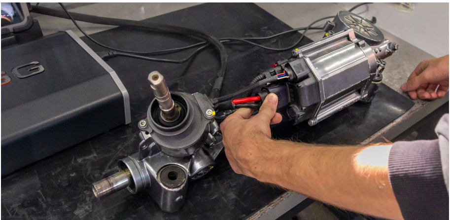
Рисунок 3. Підключення агрегату ЕПК до тестера
