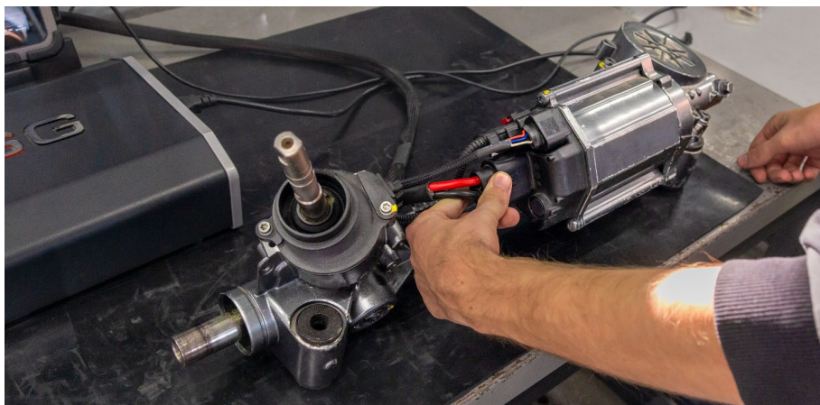
Рисунок 3. Подключение агрегата ЭУР к тестеру
