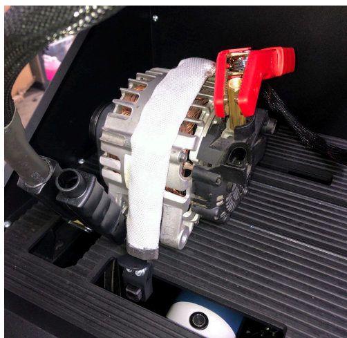
图 16. 交流发电机功率导线连接
