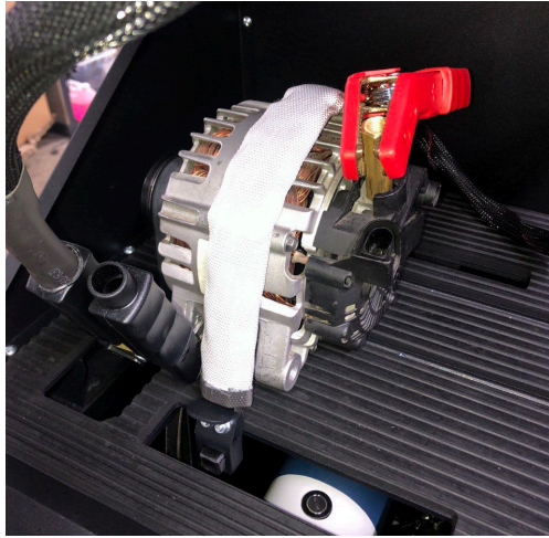
Рисунок 16. Підключення силових проводів до генератора
