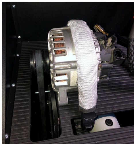
Рисунок 14. Монтаж и фиксация генератора на стенде
