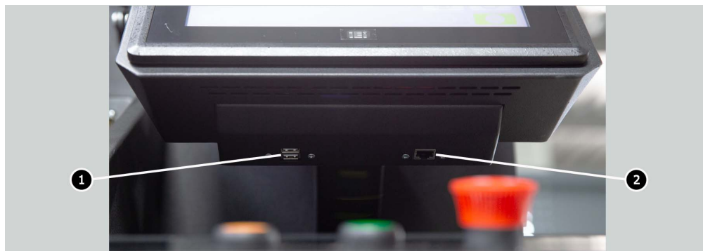
Rysunek 4. Lokalizacja złączy USB i LAN
