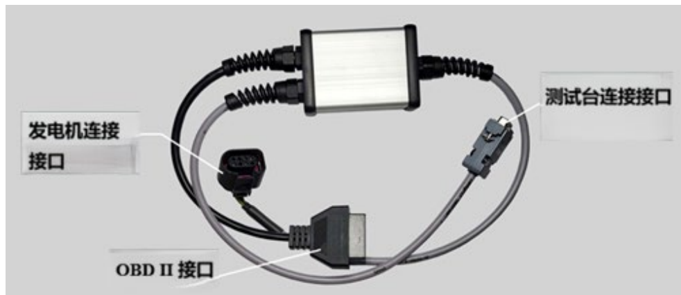
图 8. 用于检测 48V 皮带式启动交流发电机的电缆
