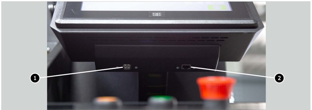
Figura 4. Ubicación de los conectores USB y LAN
