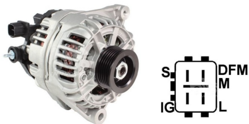
图 20. Toyota 2706020230 交流发电机及接口端子标识
