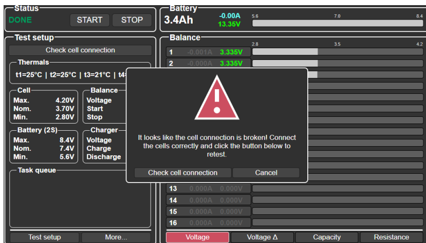
Figura 10. Notificación sobre la ausencia de conexión de una o más pinzas tipo «cocodrilo» a las celdas en los extremos de la batería.
