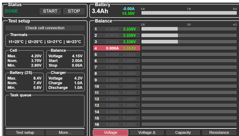
Рисунок 11. Пример информирования об отсутствии подключения одного зажима «крокодил» на 4 элементе
