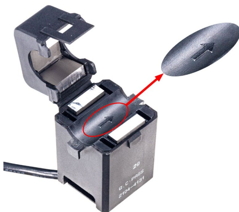
Рисунок 4. Вказівник напрямку струму на датчику
