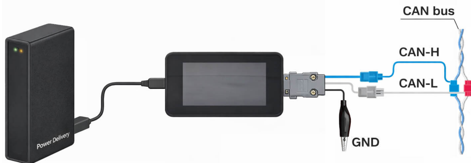
Figura 33. Ejemplo de conexión al bus CAN con alimentación desde una batería portátil.
