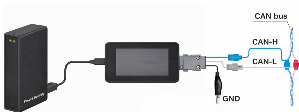
Rysunek 33. Przykład podłączenia do magistrali CAN przy zasilaniu z przenośnego akumulatora
