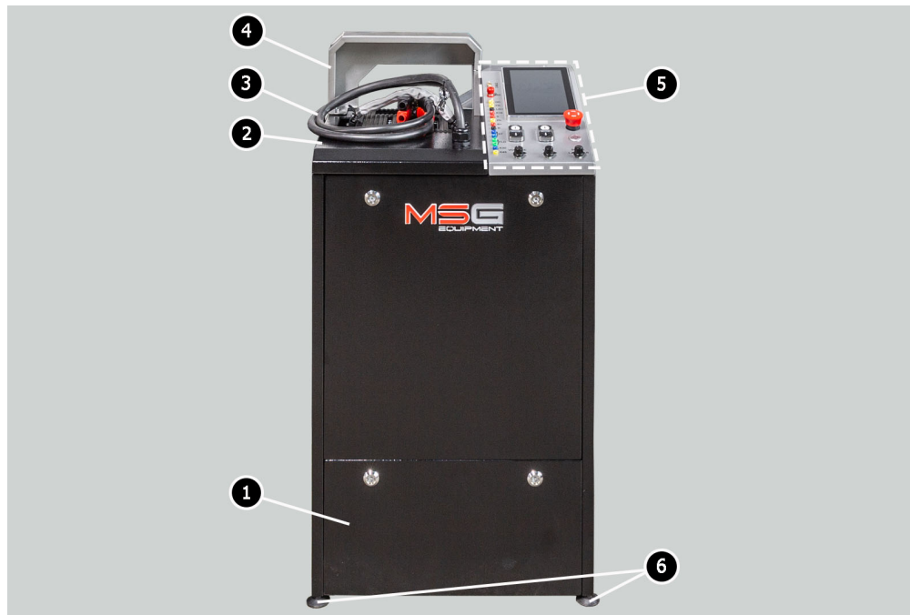
Рисунок 1. Общий вид и основные исполнительные элементы стенда
