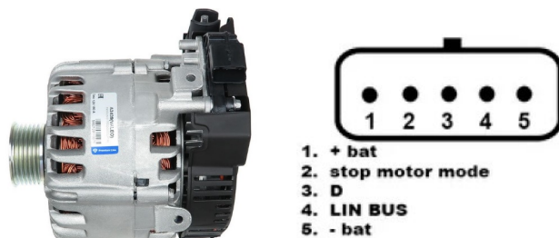
Rysunek 13. Alternator Valeo IST60C017 i oznaczenie terminali w złączu
