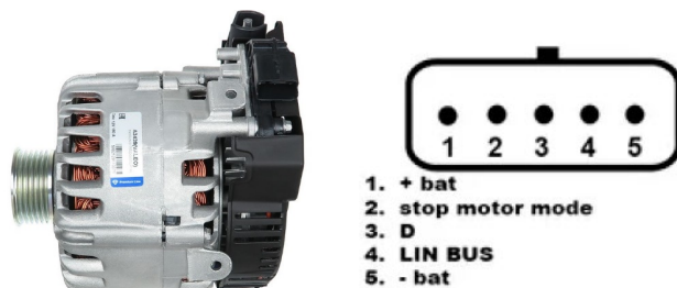
Рисунок 13. Генератор Valeo IST60C017 и обозначение терминалов в разъёме
