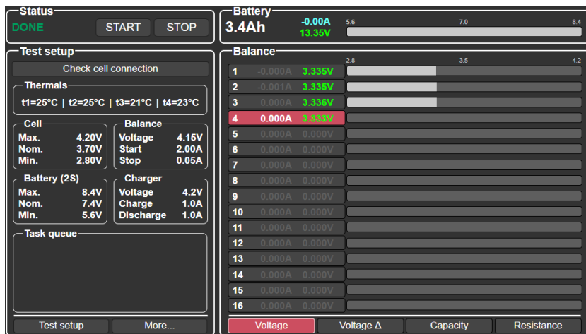
Figura 9. Ejemplo de notificación de falta de conexión de una pinza tipo "cocodrilo" en elemento 4
