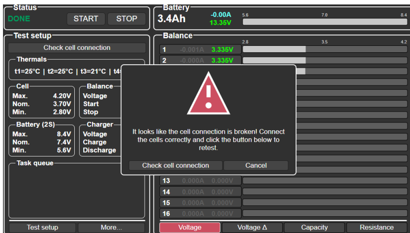
Rysunek 10. Informacja o braku połączenia zacisków „krokodyl” na skrajnych ogniwach modułu
