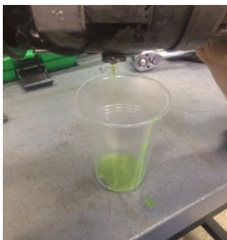
Рисунок 21. Контроль состояния масла компрессора
