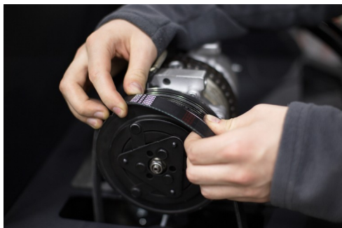
Рисунок 24. Установка ремня и проверка степени его натяжения
