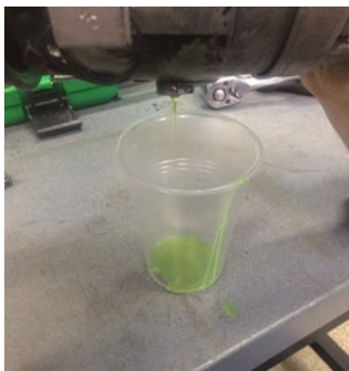
Rysunek 21. Kontrola stanu oleju sprężarki
