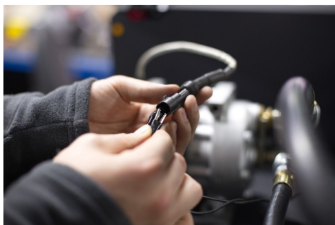
Рисунок 27. Подключение управляющих проводов к компрессору
