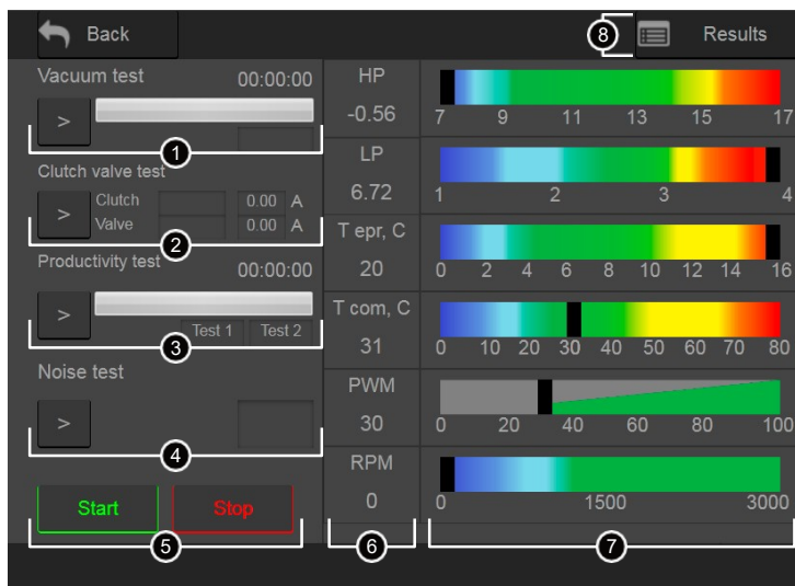
Рисунок 7. Окно автоматической диагностики компрессора
