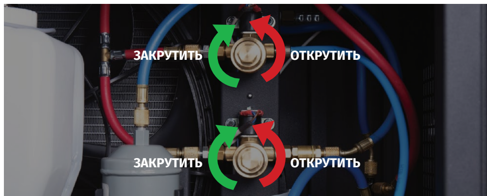
Рисунок 41. Направление вращения крышки при замене фильтров MS0102
