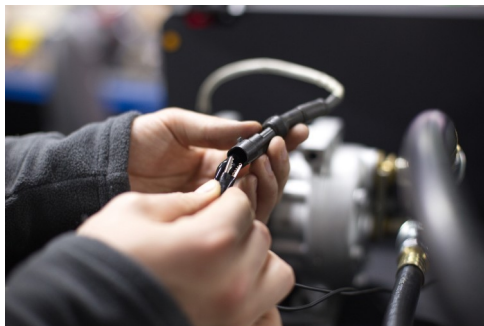
Rysunek 27. Podłączenie przewodów sterujących do sprężarki
