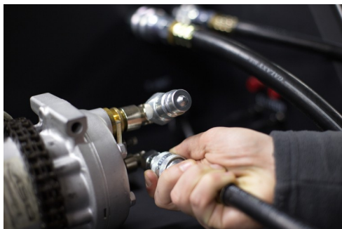
Рисунок 25. Подключения шлангов LP и HP к компрессору
