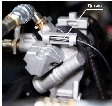
Рисунок 29. Позиціонування контактного датчика температури
