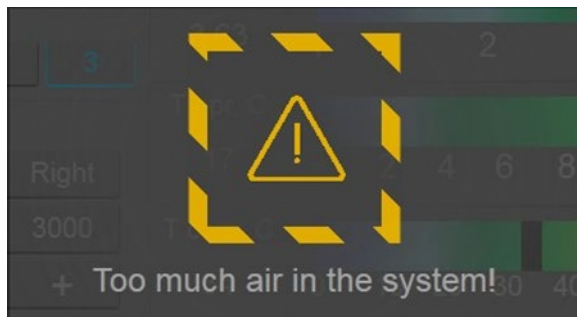
Rysunek 35. Komunikat „Za dużo powietrza w układzie”
