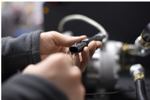
Rysunek 27. Podłączenie przewodów sterujących do sprężarki
