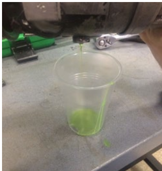
Figura 21. Control de estado del aceite del compresor
