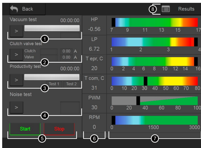
Rysunek 7. Okno automatycznej diagnostyki sprzężarki
