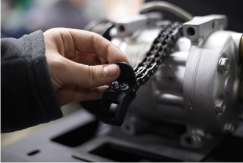
Рисунок 23. Встановлення компресора на стенд і його фіксація
