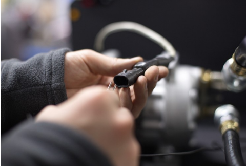
Рисунок 27. Підключення керуючих проводів до компресора
