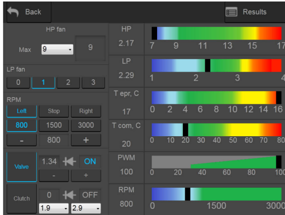
Рисунок 32. Налаштування стенда під час обкатування компресора
