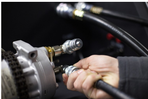
Figura 25. Conexión de las mangueras LP y HP al compresor
