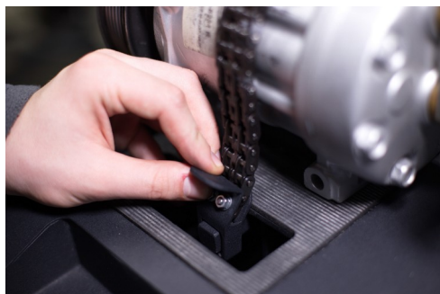
Рисунок 23. Установка компрессора на стенд и его фиксация
