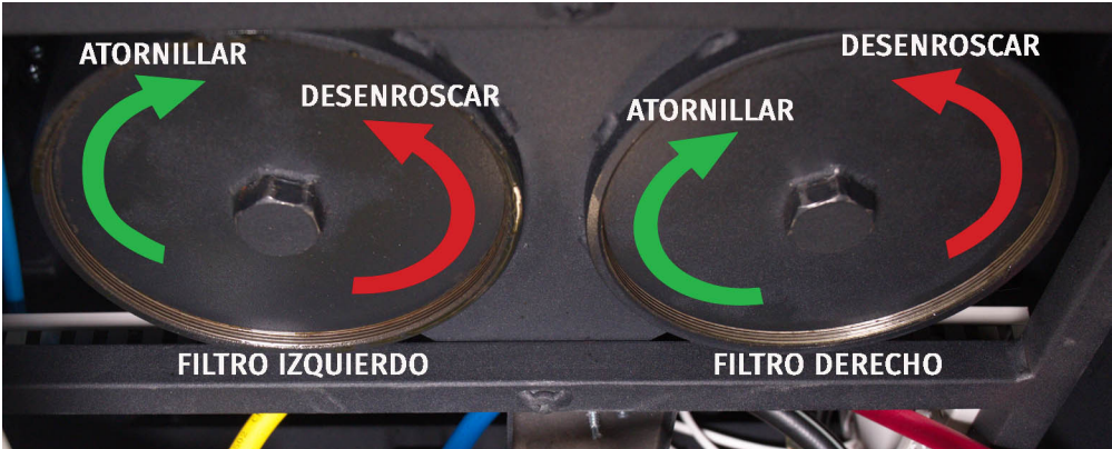
Figura 37. Dirección de rotación de la tapa al cambiar los filtros MS0101
