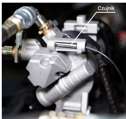
Rysunek 29. Pozycjonowanie dotykowego Czujnika temperatury
