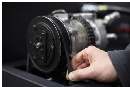
Rysunek 24. Montaż pasa i kontrola stopnia jego napięcia
