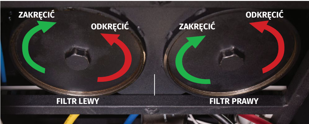
Rysunek 37. Kierunek obrotu pokryw przy wymianie filtrów MS0101
