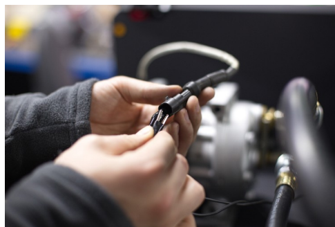
Figura 27. Conexión de los cables de control al compresor
