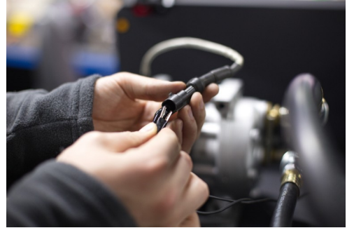
Рисунок 27. Підключення керуючих проводів до компресора
