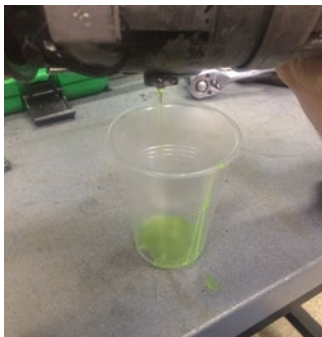
Рисунок 21. Контроль стану мастила компресора
