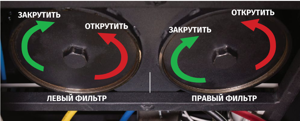
Рисунок 37. Направление вращения крышки при замене фильтров MS0101
