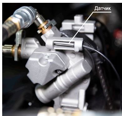
Рисунок 29. Позиционирование контактного датчика температуры
