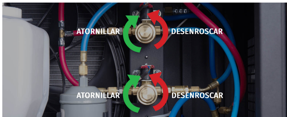
Figura 41. Dirección de rotación de la tapa al cambiar los filtros MS0102
