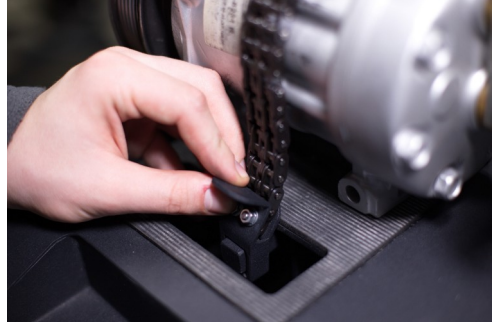
Рисунок 23. Встановлення компресора на стенд і його фіксація
