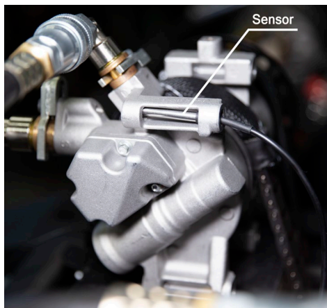
Figura 29. Posicionamiento del sensor de temperatura con contacto
