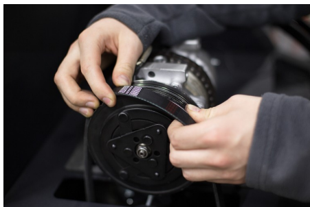
Rysunek 24. Montaż pasa i kontrola stopnia jego napięcia
