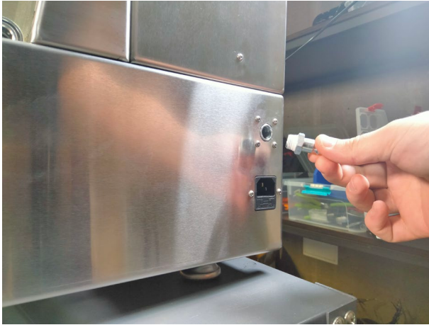
Figura 3. Montaje de la boquilla de conexión rápida para conectar una fuente de aire comprimido
