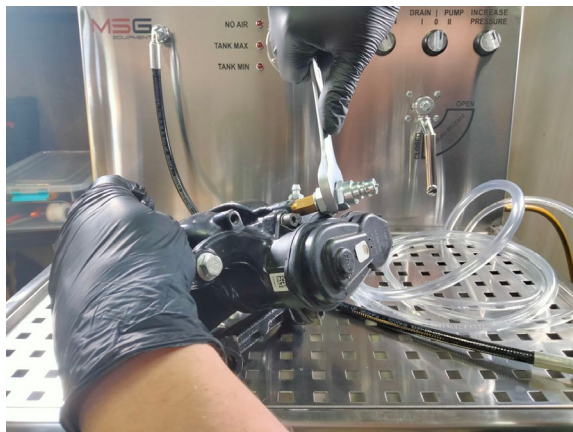
Рисунок 9. Установка штуцера с адаптером на суппорт
