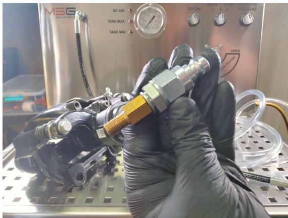
Рисунок 8. Штуцер і адаптер, підібраний під різьбу супорта
