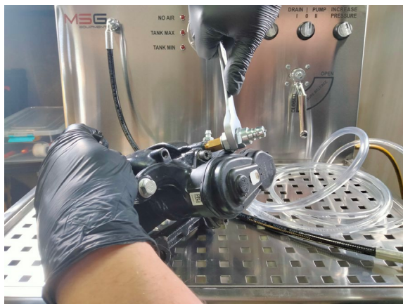
Figura 9. Montaje de la boquilla con el adaptador en la pinza
