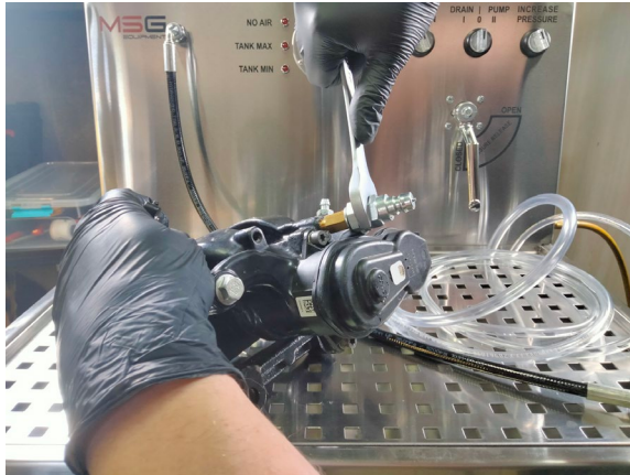
Рисунок 9. Встановлення штуцера з адаптером на супорт
