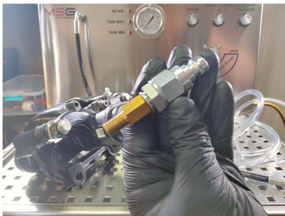
Figura 8. Boquilla y adaptador adaptados a la rosca de la pinza
