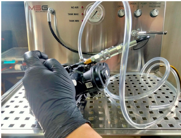
Figura 11. Tubería de PVC conectada para bombeo
