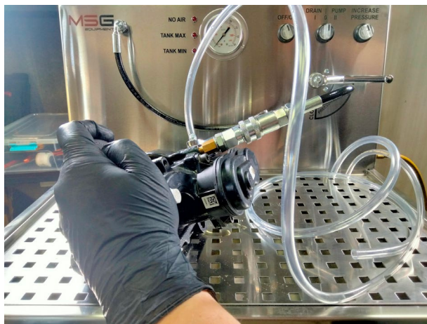
Rysunek 11. Podłączona rurka PVC do odpowietrzania
