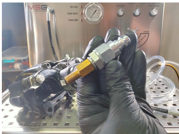
Rysunek 8. Złączka odpowietrzająca i adapter dopasowany do gwintu zacisku
