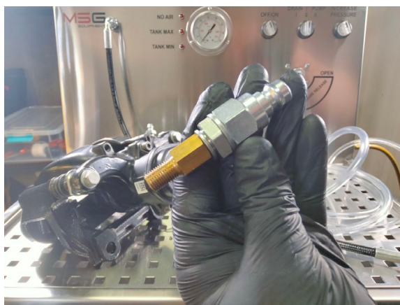
Рисунок 8. Штуцер и адаптер, подобранный под резьбу суппорта
