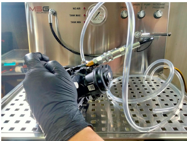
Рисунок 11. Під'єднана ПВХ трубка для прокачування
