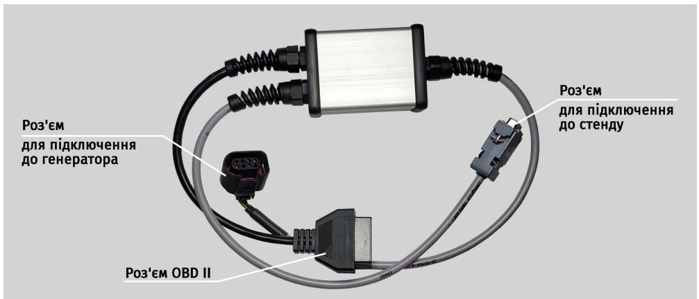
Рисунок 8. Кабель для перевірки ремінних стартер-генераторів 48 В
