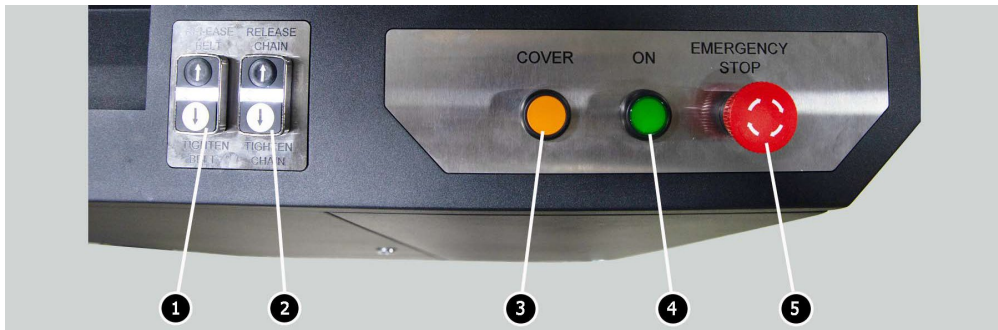
Figura 3. Panel de control del banco de pruebas
