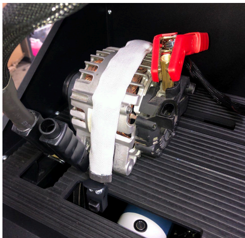
Рисунок 16. Подключение силовых проводов к генератору
