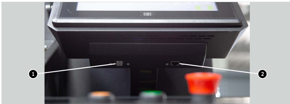
Figura 4. Ubicación de los conectores USB y LAN
