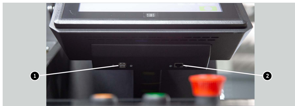
Рисунок 4. Розташування роз'ємів USB і LAN
