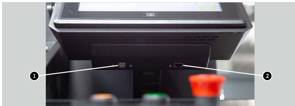
Rysunek 4. Lokalizacja złączy USB i LAN
