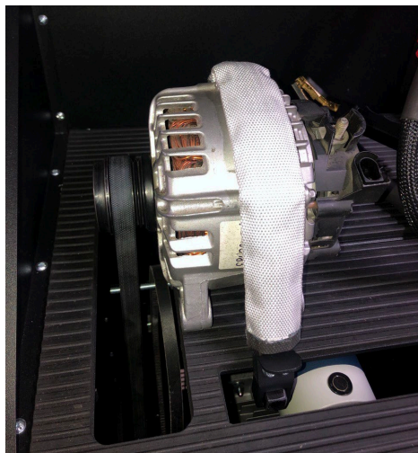
Рисунок 14. Монтаж и фиксация генератора на стенде
