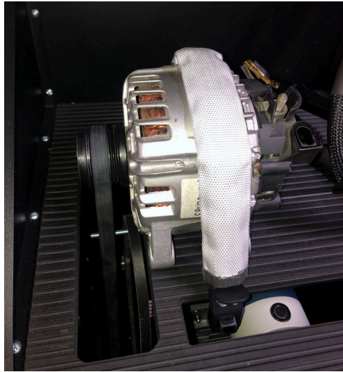
Figura 14. Montaje y fijación del alternador en del banco de pruebas
