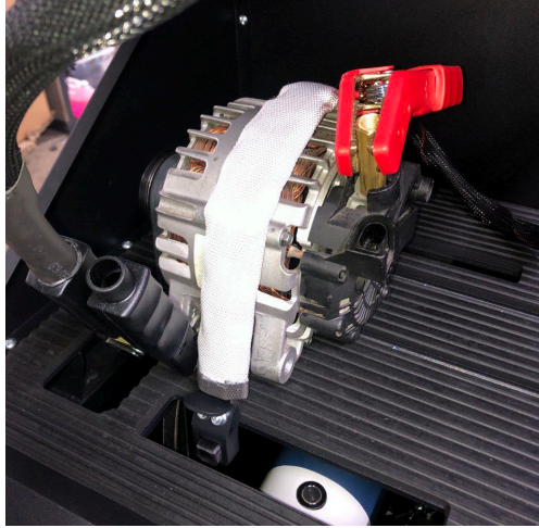
Рисунок 16. Підключення силових проводів до генератора
