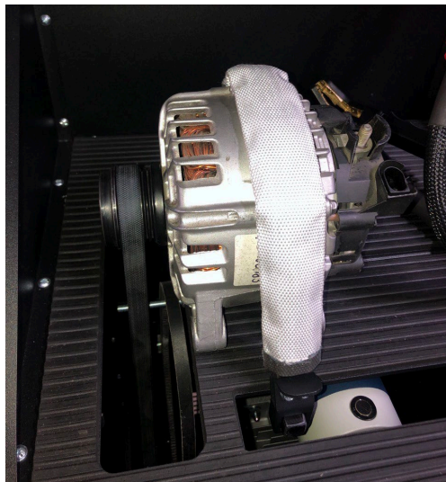
Rysunek 14. Montaż i zamocowanie alternatora na stanowisku
