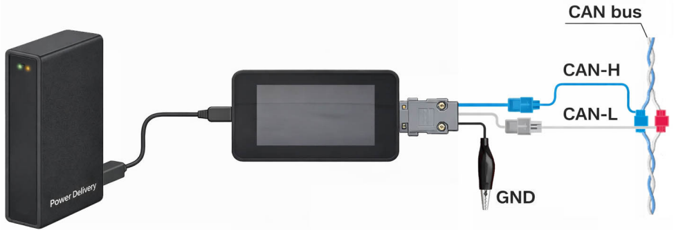
Рисунок 33. Приклад підключення до шини CAN при живленні від портативного акумулятора
