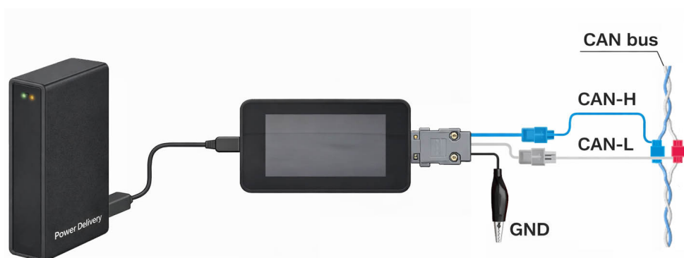
Figura 33. Ejemplo de conexión al bus CAN con alimentación desde una batería portátil.
