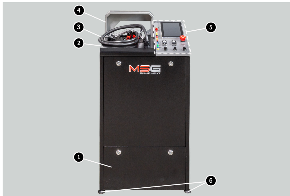
Рисунок 1. Загальний вигляд і основні виконавчі елементи стенда
