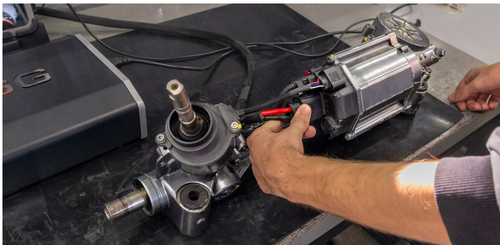
Figura 3. Conexión de la unidad de EPS al probador
