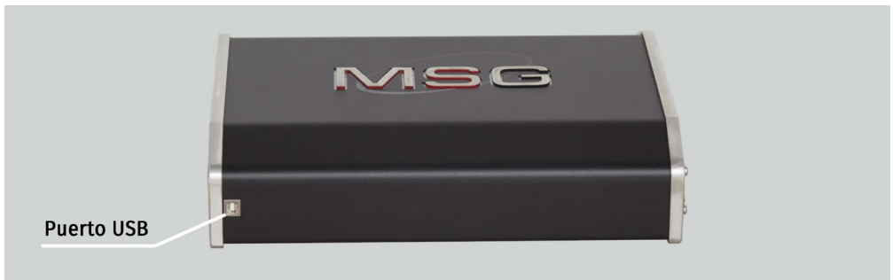
Figura 2. Ubicación del puerto USB en la carcasa del probador
