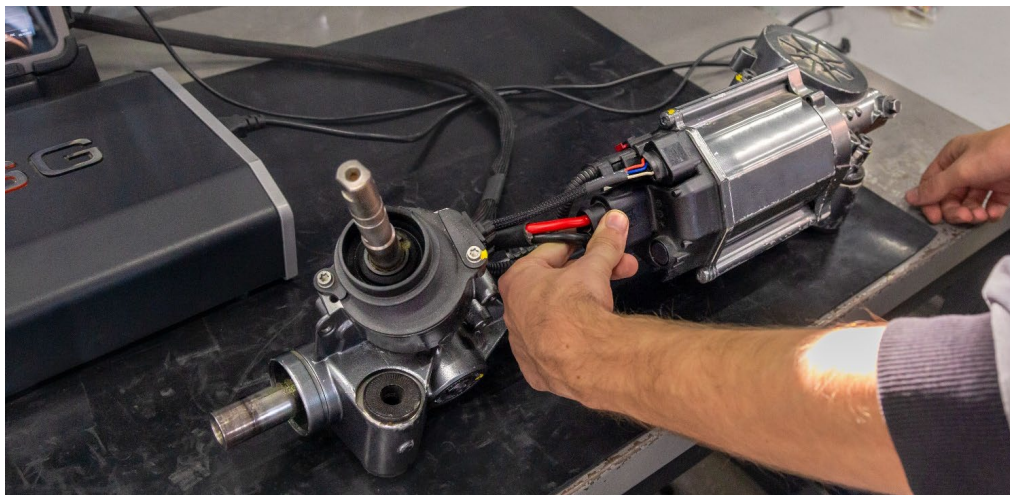
Rysunek 3. Podłączenie urządzenia elektrycznego wspomagania układu kierowniczego do testera
