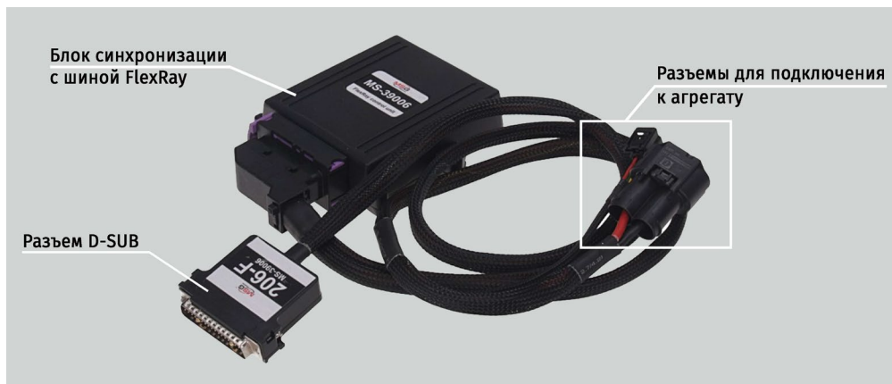
Рисунок 7. Специализированный кабель FlexRay
