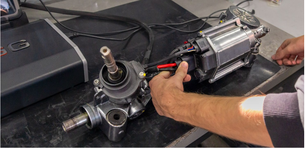
Рисунок 3. Підключення агрегату ЕПК до тестера
