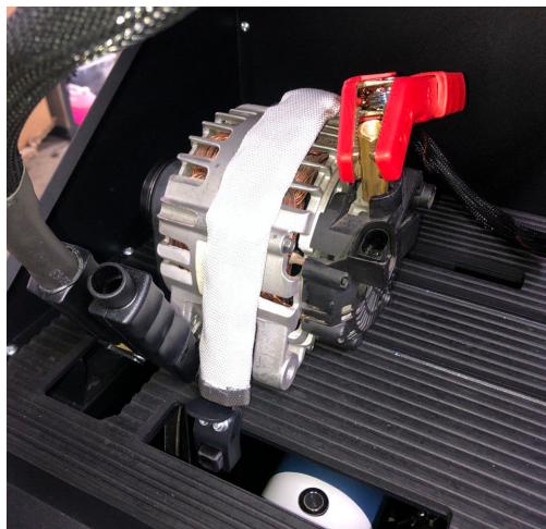
Рисунок 16. Подключение силовых проводов к генератору
