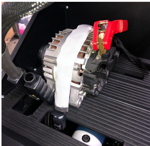
Рисунок 16. Підключення силових проводів до генератора
