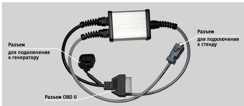
Рисунок 8. Кабель для проверки ременных стартер-генераторов 48 В
