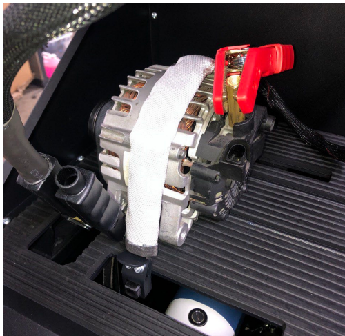
Figura 16. Conexión de los cables de alimentación al alternador
