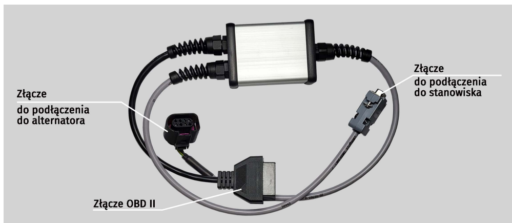
Rysunek 8. Kabel do badania pasowych alternatorów-rozruszników 48 V
