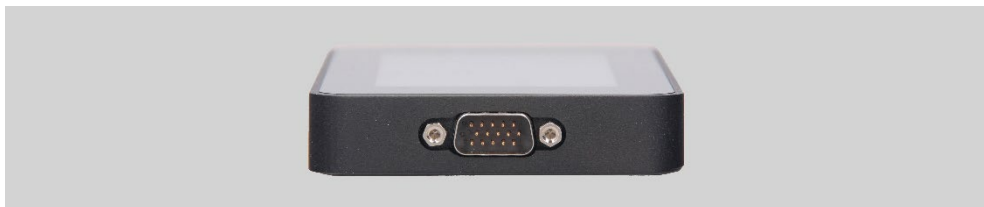
Rysunek 2. Złącze do podłączenia kabli diagnostycznych
