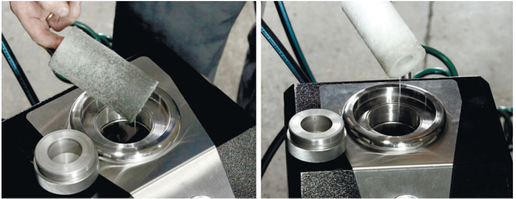
Рисунок 4. Фільтрувальний елемент після першого циклу промивання (ліворуч) і після закінчення промивання (праворуч).
