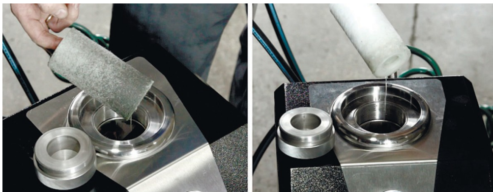
Rysunek 4. Element filtrujący po pierwszym cyklu płukania (po lewej stronie) i po zakończeniu płukania (po prawej stronie).
