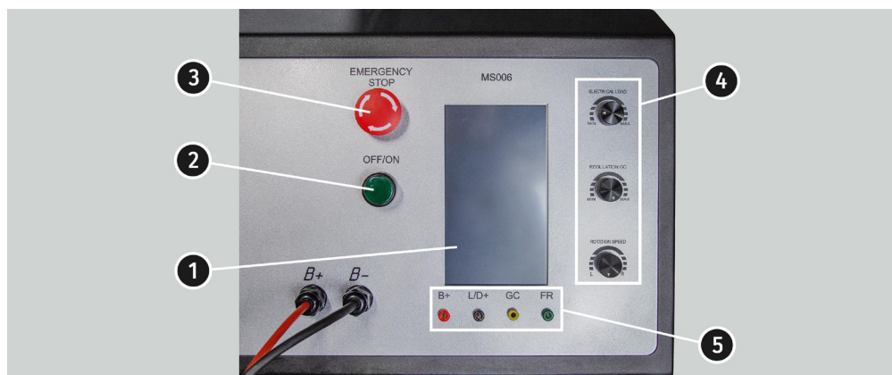
Figura 2. Panel de control del banco de pruebas
