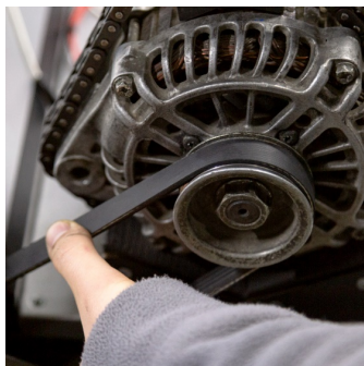
Рисунок 17. Проверка натяжения ремня генератора
