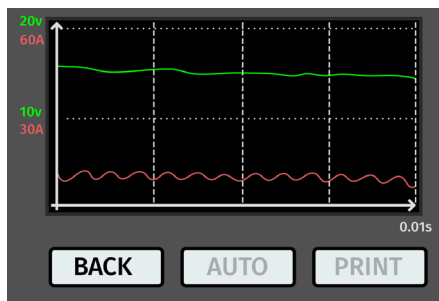
Rysunek 12. Graficzne wyświetlanie mierzonego napięcia i prądu badanego alternatora
