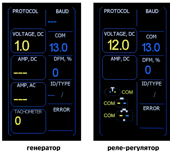
Рисунок 9. Экран стенда при диагностике генераторов/реле-регуляторов типа COM
