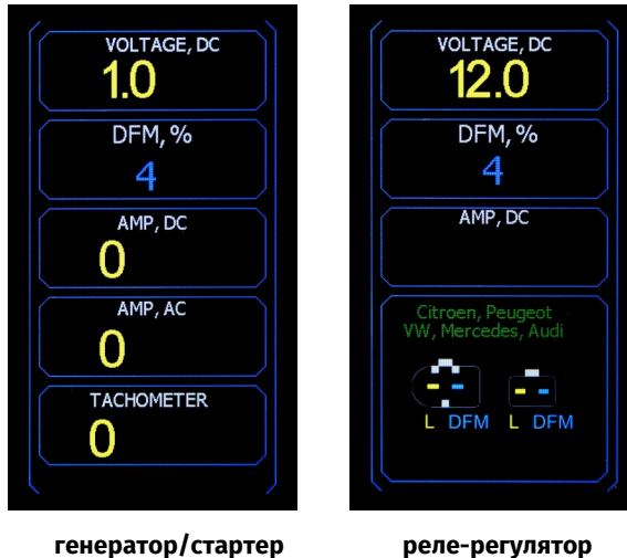
Рисунок 4. Екран стенда під час діагностики генератора/реле-регулятора типу Lamp або стартера
