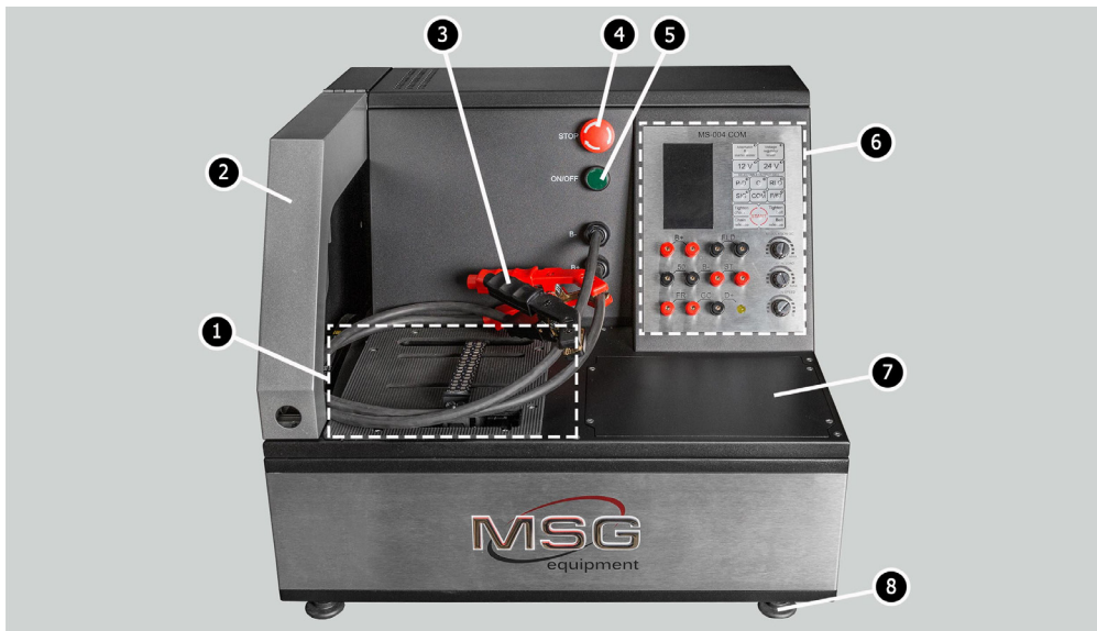
Figura 1. Elementos básicos del banco de pruebas
