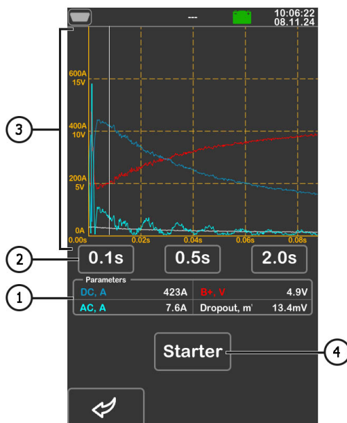
Figura 14. Menú del modo de prueba de motor de arranque
