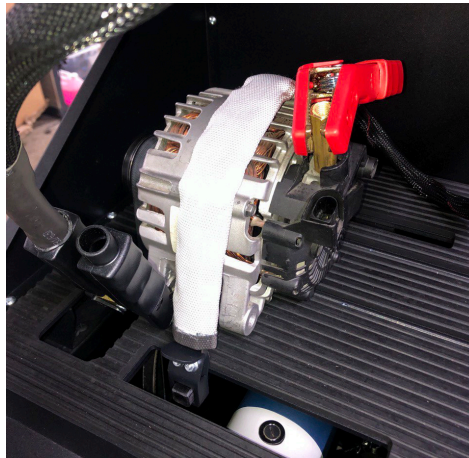
Рисунок 13. Підключення силових проводів до генератора
