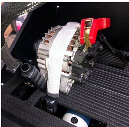
Рисунок 13. Подключение силовых проводов к генератору
