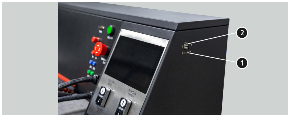
Рисунок 3. Разъёмы на боковой панели стенда: 1 – HDMI; 2 – USB
