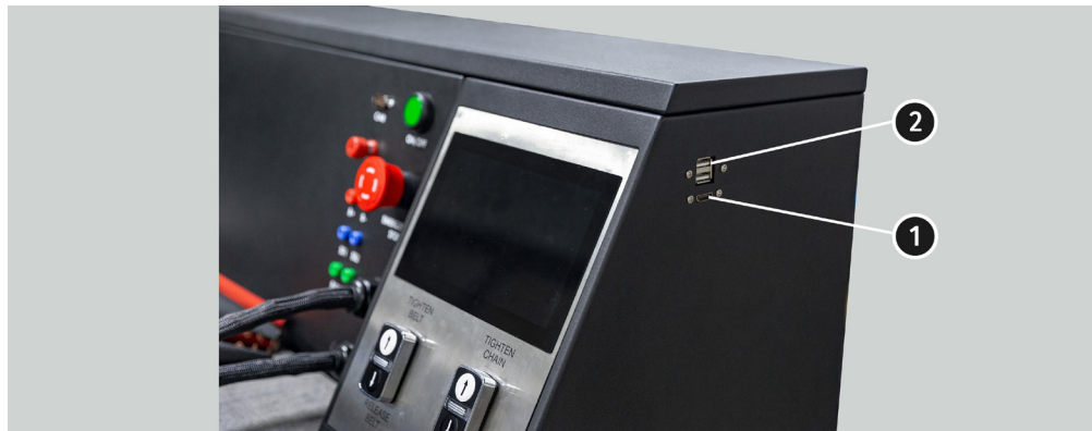
Рисунок 3. Роз'єми на бічній панелі стенда: 1 – HDMI; 2 – USB
