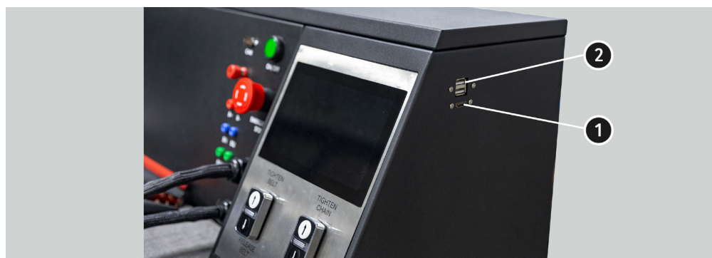
Figura 3. Conectores del panel lateral de la máquina: 1 – HDMI; 2 – USB
