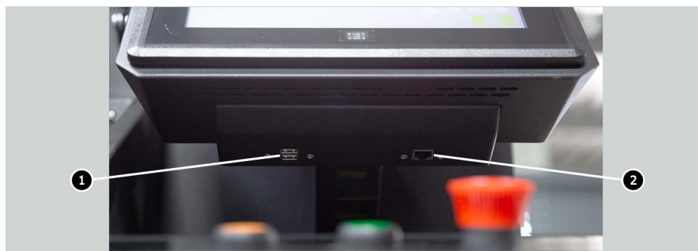
Figura 4. Ubicación de los conectores USB y LAN
