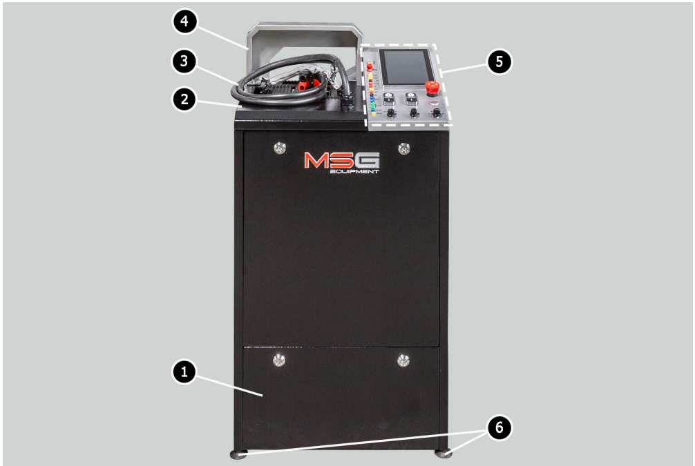
Figura 1. Vista general y principales elementos de accionamiento del banco
