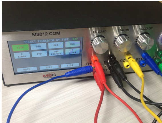
Figura 19. Conexión de un cable B+ adicional
