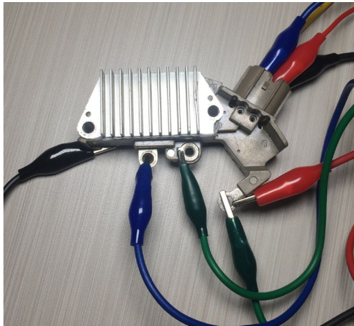
Рисунок 18. Регулятор ARE6076, під'єднаний до роз'ємів тестера
