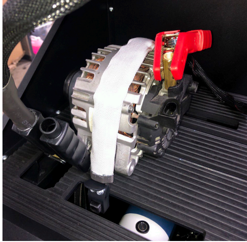
Figura 16. Conexión de los cables de alimentación al alternador
