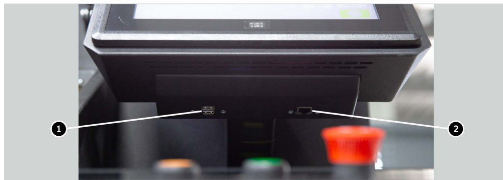
Figura 4. Ubicación de los conectores USB y LAN
