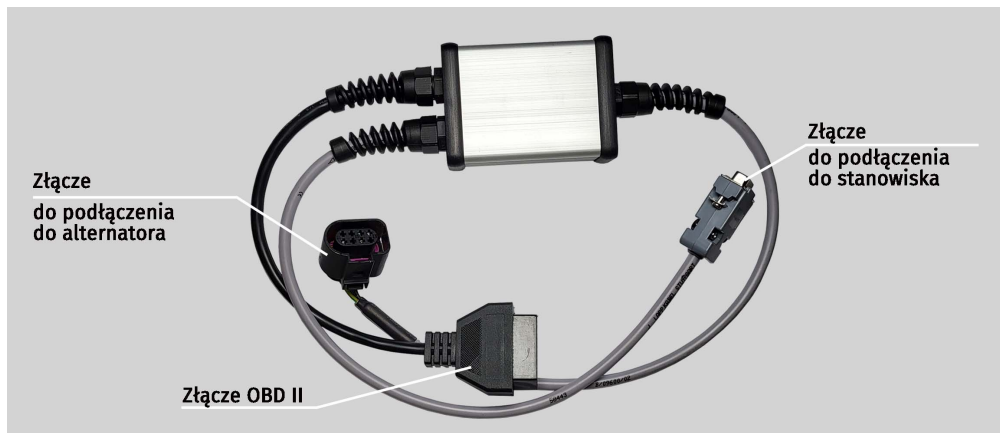
Rysunek 8. Kabel do badania pasowych alternatorów-rozruszników 48 V
