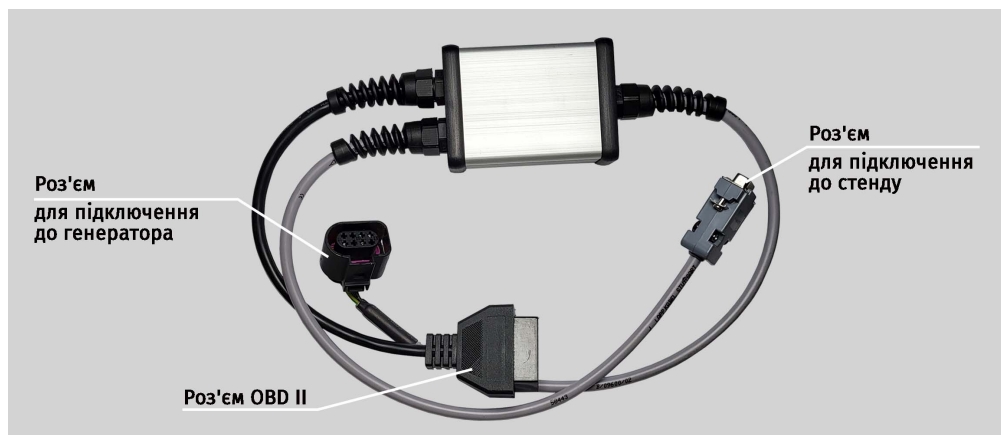
Рисунок 8. Кабель для перевірки ремінних стартер-генераторів 48 В
