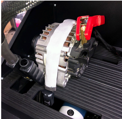
Figura 13. Conexión de los cables de alimentación al alternador
