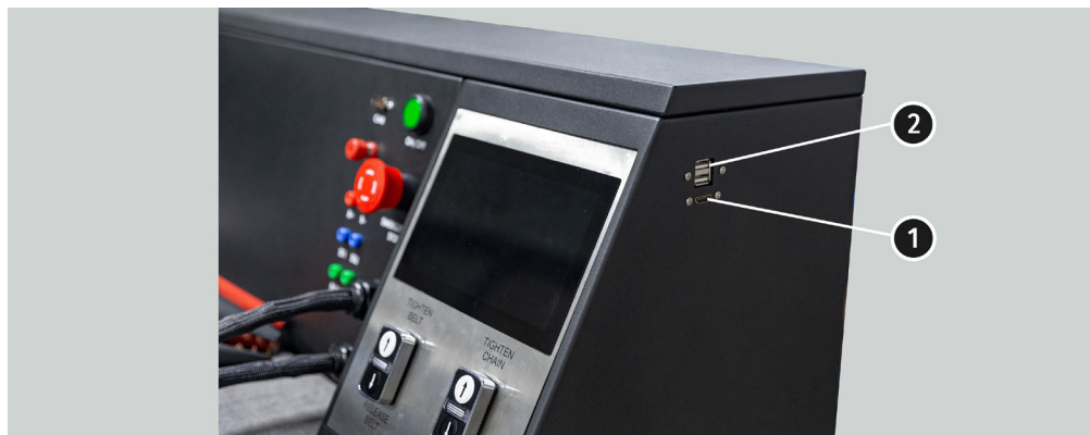
Рисунок 3. Разъёмы на боковой панели стенда: 1 – HDMI; 2 – USB
