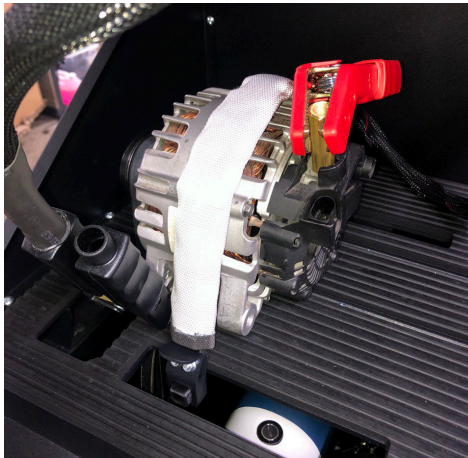
Рисунок 13. Підключення силових проводів до генератора
