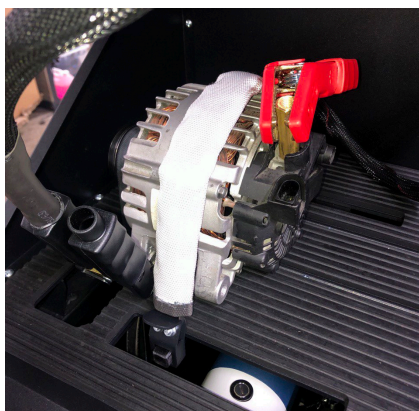
Рисунок 13. Подключение силовых проводов к генератору
