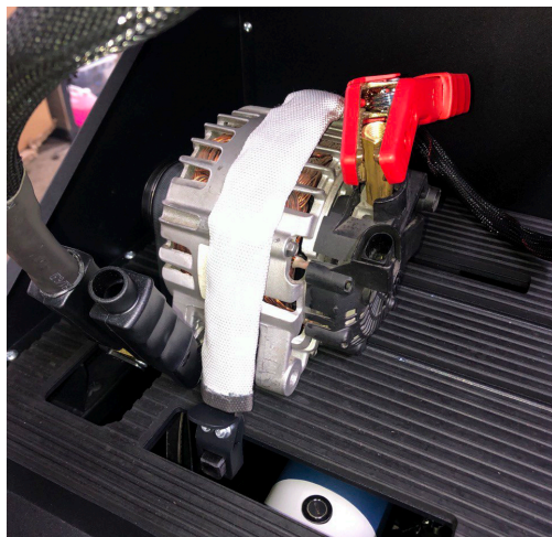
Rysunek 13. Podłączenie przewodów zasilających do alternatora
