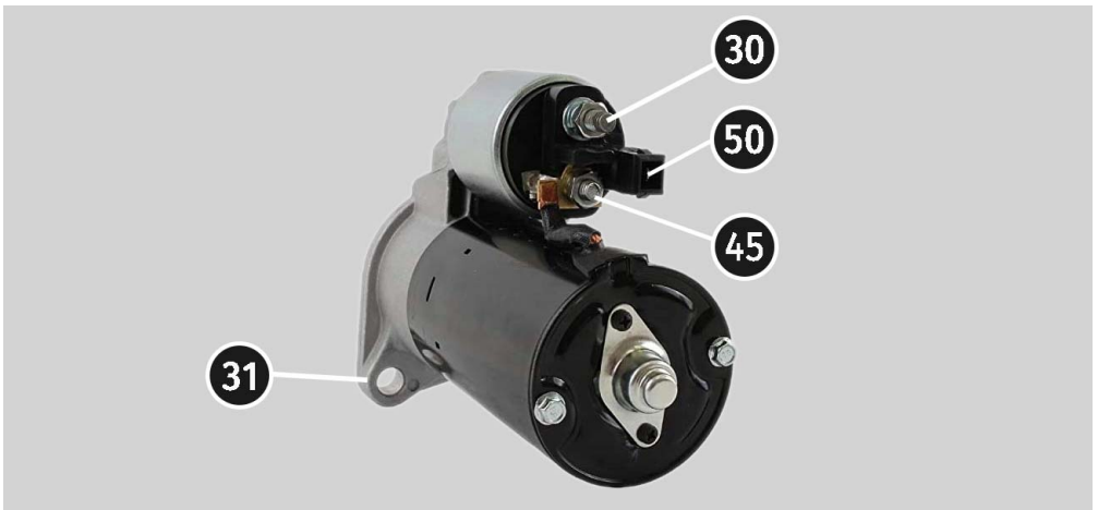
Figura 25. Ubicación de los bornes en el motor de arranque
