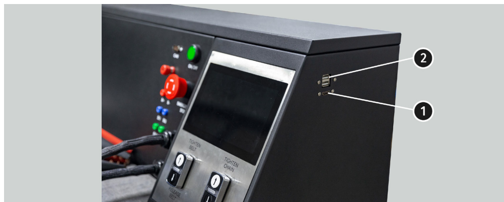
Rysunek 3. Złącza na panelu bocznym stanowiska: 1 – HDMI; 2 – USB
