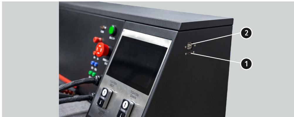
Рисунок 3. Роз'єми на бічній панелі стенда: 1 – HDMI; 2 – USB
