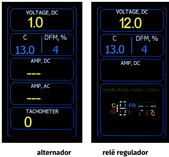
Figura 6. Pantalla del banco de pruebas durante el diagnóstico del alternador/relé regulador del tipo C
