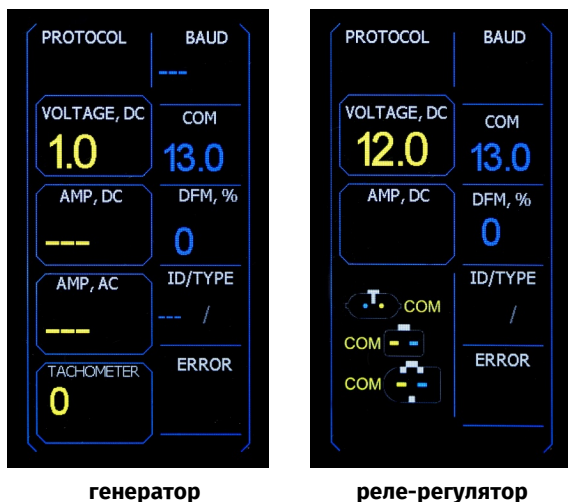
Рисунок 9. Экран стенда при диагностике генераторов/реле-регуляторов типа COM
