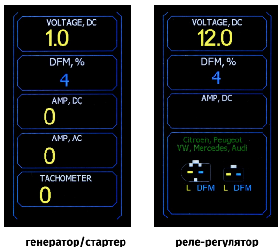
Рисунок 4. Экран стенда при диагностике генератора/реле-регулятора типа Lamp или стартера
