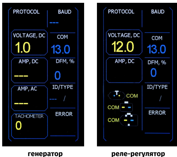
генератор реле-регулятор Рисунок 9. Екран стенда під час діагностики генераторів/реле-регуляторів типу COM
