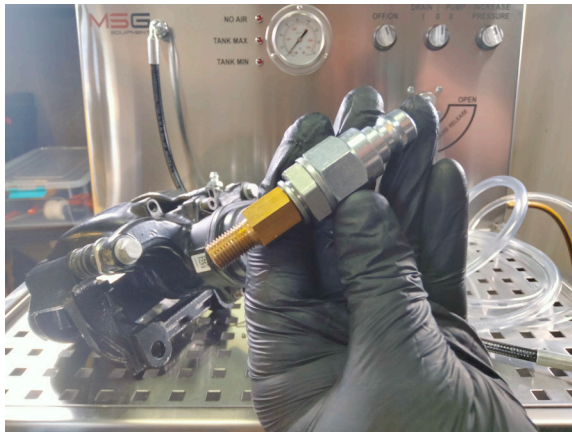
Рисунок 8. Штуцер і адаптер, підібраний під різьбу супорта
