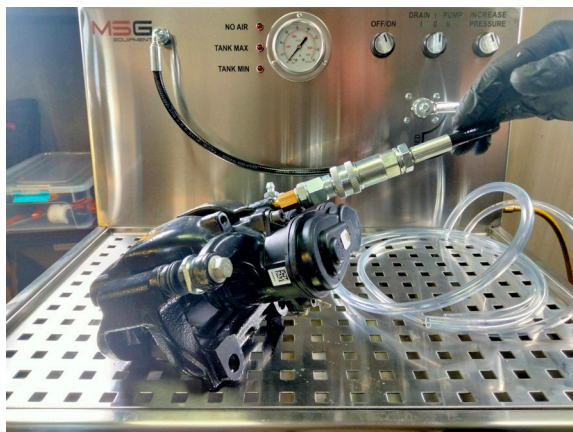
Rysunek 10. Podłączenie przewodu wysokociśnieniowego
