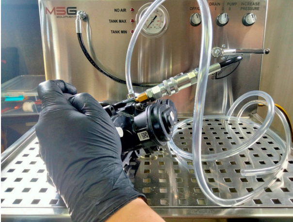
Рисунок 11. Під'єднана ПВХ трубка для прокачування
