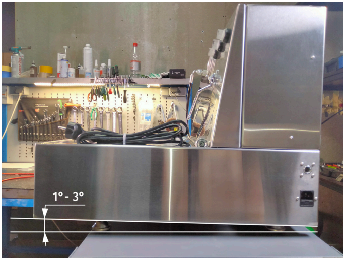
Figura 2. Posición correcta de la máquina
