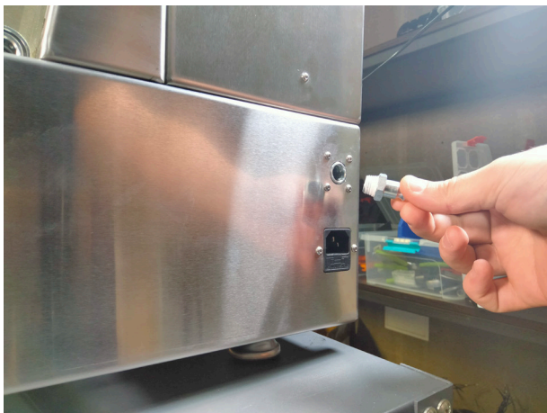
Рисунок 3. Монтаж штуцер быстроразъемного соединения для подключения источника сжатого воздуха
