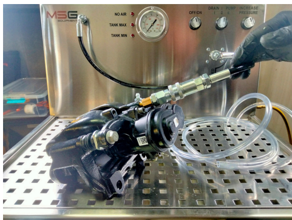
Рисунок 10. Підключення рукава високого тиску
