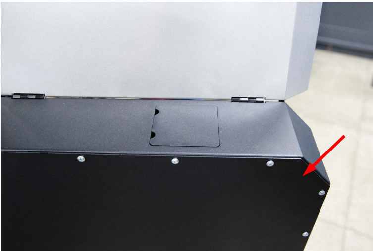
Рисунок 1. Панель корпусу стенда, яку необхідно демонтувати
