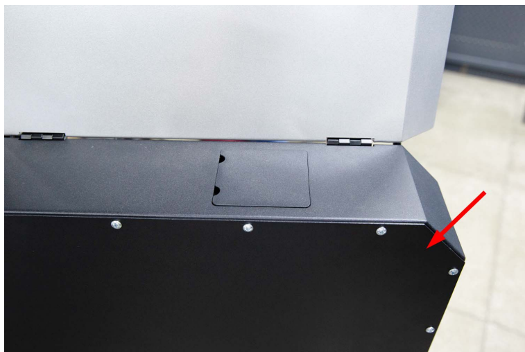
Рисунок 1. Демонтируемая панель корпуса стенда
