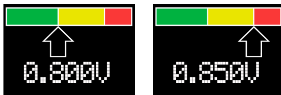
Рисунок 5. Меню налаштування порогових значень колірної індикації
