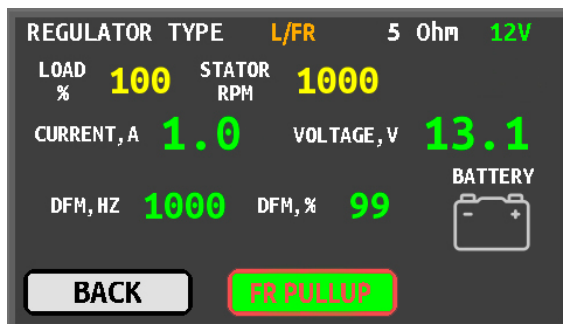
Rysunek 10. Ekran diagnostyczny regulatora L/FR (12/24V)
