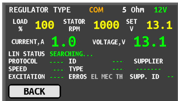
Rysunek 12. Ekran diagnostyczny regulatora COM 12V
