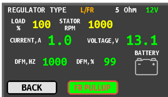
Рисунок 10. Экран диагностики регулятора L/FR (12/24V)
