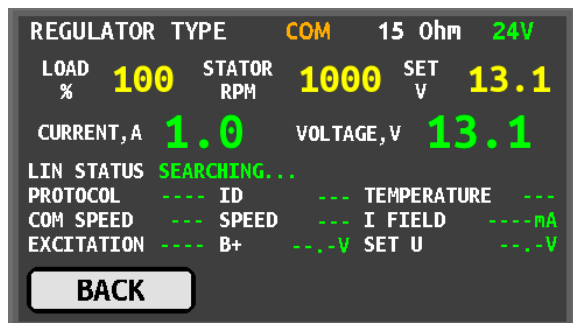
Рисунок 13. Экран диагностики регулятора COM 24V
