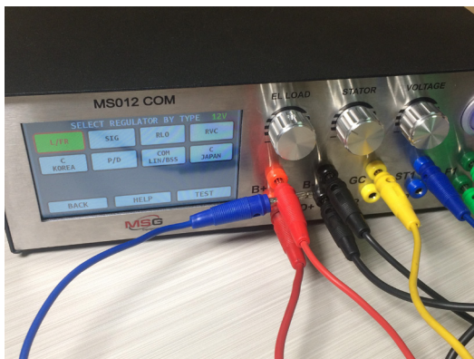
Рисунок 19. Підключення додаткового провodu В+
