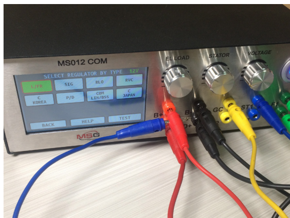
Рисунок 19. Подключение дополнительного провода В+
