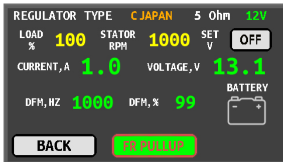
Рисунок 9. Экран диагностики регулятора C JAPAN
