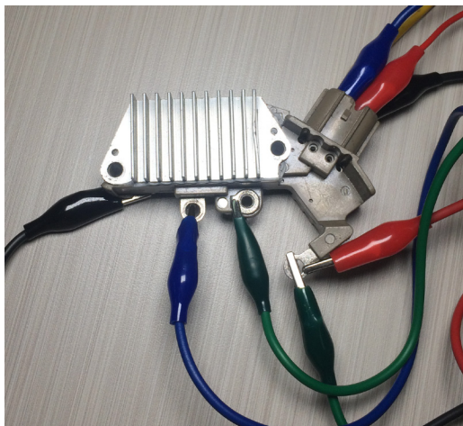
Rysunek 18. Regulator ARE6076 podłączony do wyprowadzeń testera
