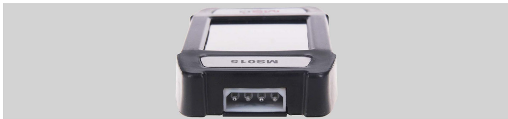
Rysunek 2. Złącze do podłączenia kabla diagnostycznego
