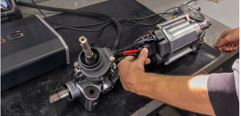
Figura 3. Conexión de la unidad de EPS al probador
