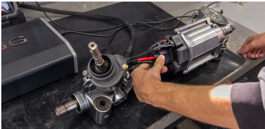
Рисунок 3. Підключення агрегату ЕПК до тестера
