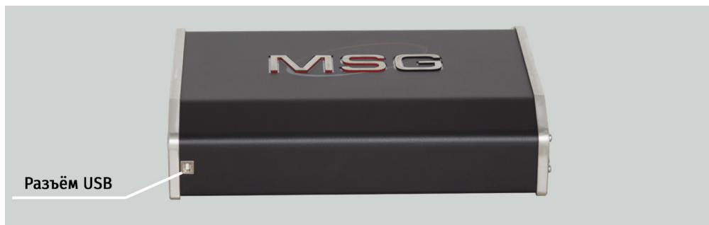
Рисунок 2. Расположение USB разъема на корпусе тестера
